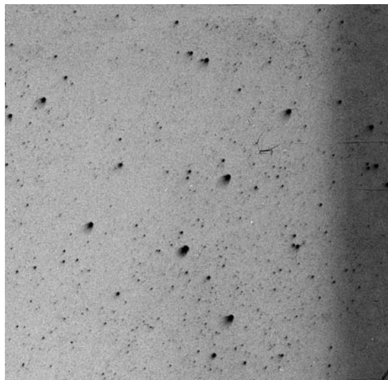
Рис. 3.4. Угловой участок той же самой пластинки, что и на рис. 3.1. Размер участка примерно 1^\circ \times 1^\circ . Хорошо видно влияние aberrации комы. Изображения вытянуты в направлении на центр пластинки
